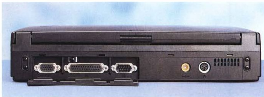
Sul pannello posteriore ci sono le consuete interfacce (seriale, parallela, video) e le connessioni per l'alimentazione e per un mouse esterno.
